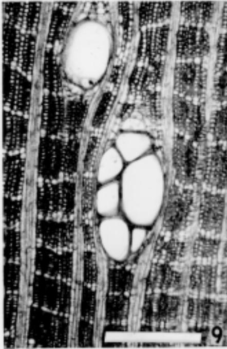
**Figura 9** - *Eschweilera matamata*: corte transversal mostrando vaso múltiplo em cacho e parênquima axial apotraqueal (partes claras estreitas); escala de 200  $\mu\text{m}$ .
